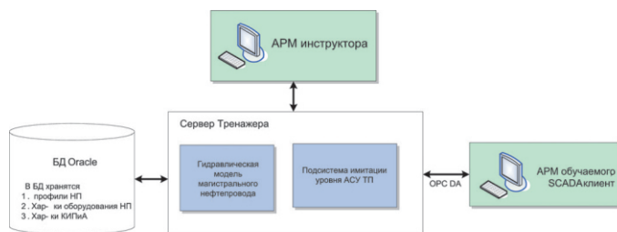
Рис. 1. Структурная схема «Тренажера диспетчера»
